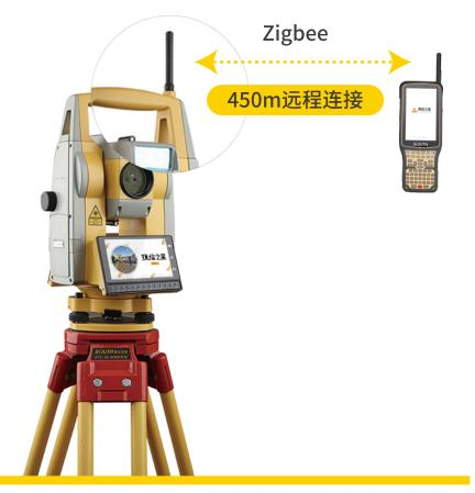
当遇到大量的放样数据或验收工程时,就可以用到跟踪测量功能,让仪器锁定棱 镜进行跟踪,在测量过程中随停随测,提高作业效率。即使在棱镜跟踪过程中由于速度 过快、障碍物遮挡等原因而停止跟踪,仪器也会自动根据设置的时间等待棱镜重新进入 视场范围内并继续测量。
